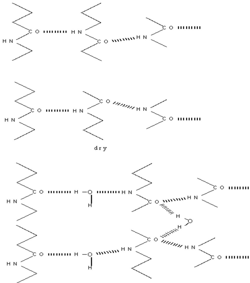
Figure 7 : Liaisons hydrogène entre les molécules d'eau et les groupements polaires du polyamide, plastification <sup>[34]</sup>
