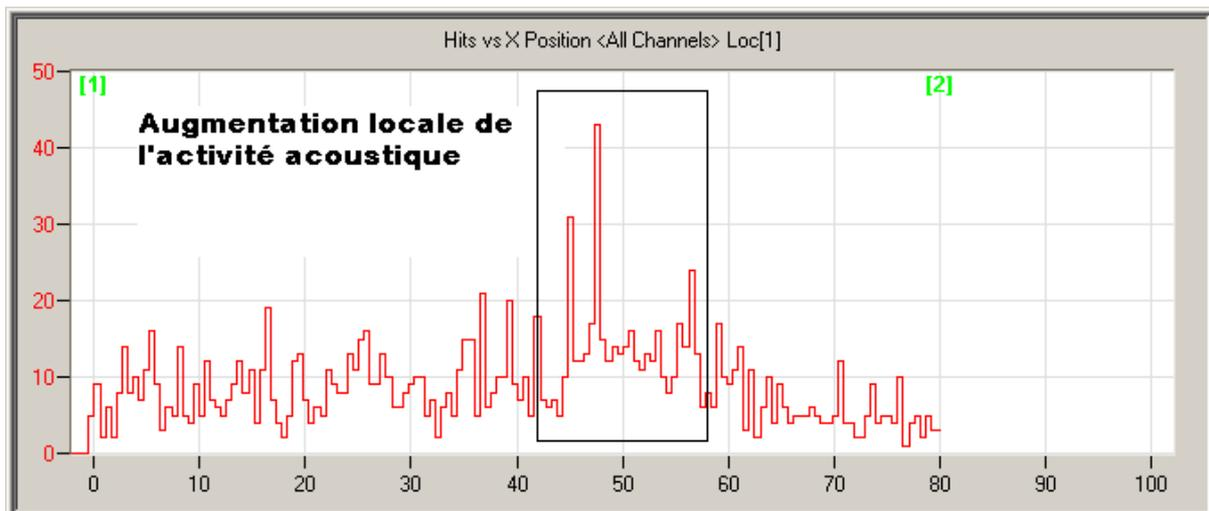
**Figure 98 : Localisation des coups sur une éprouvette de Carbostamp™ PA6 unidirectionnelle soumise à un chargement monotone en traction longitudinale-mise en évidence d'une zone de forte activité acoustique**
