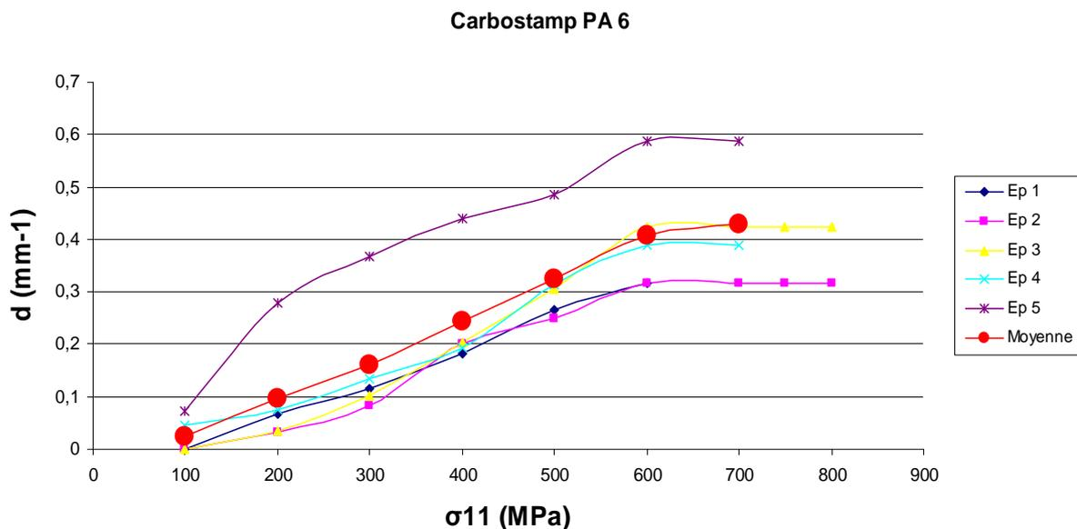
Figure 71 : Courbes expérimentales de l'évolution de la densité de fissures  $d$  au cours du chargement imposé pour un stratifié  $[0^\circ_2, 90^\circ_2]_s$  de Carbostamp™ PA 6
