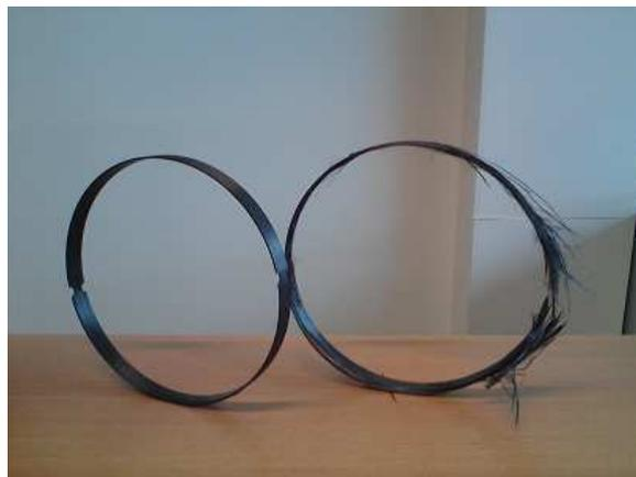
Figure 110 : Localisation de la rupture avec l'insertion d'entailles
