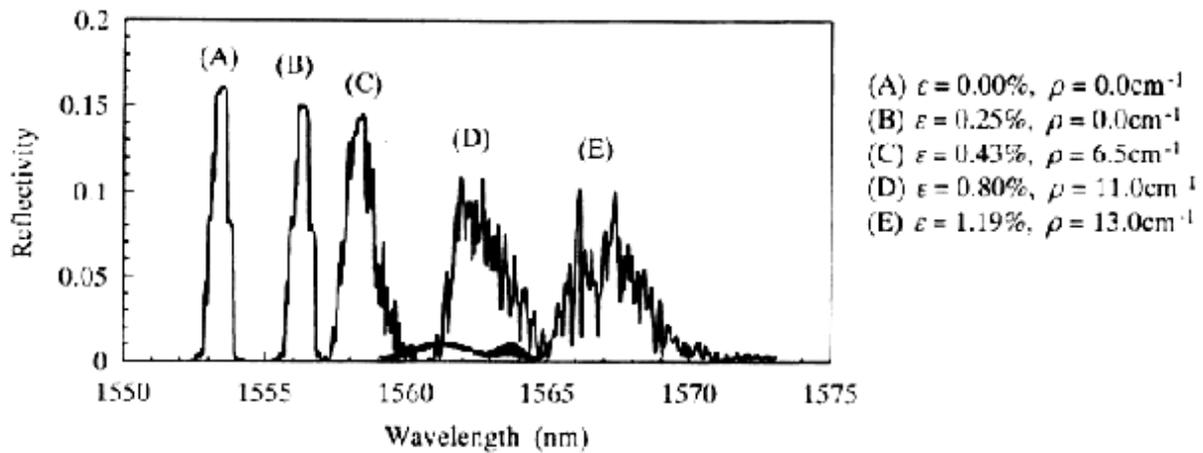
Figure 27 : Influence de la densité de fissure transverse sur le spectre de réflexion d'une fibre optique à réseaux de Bragg [101]
