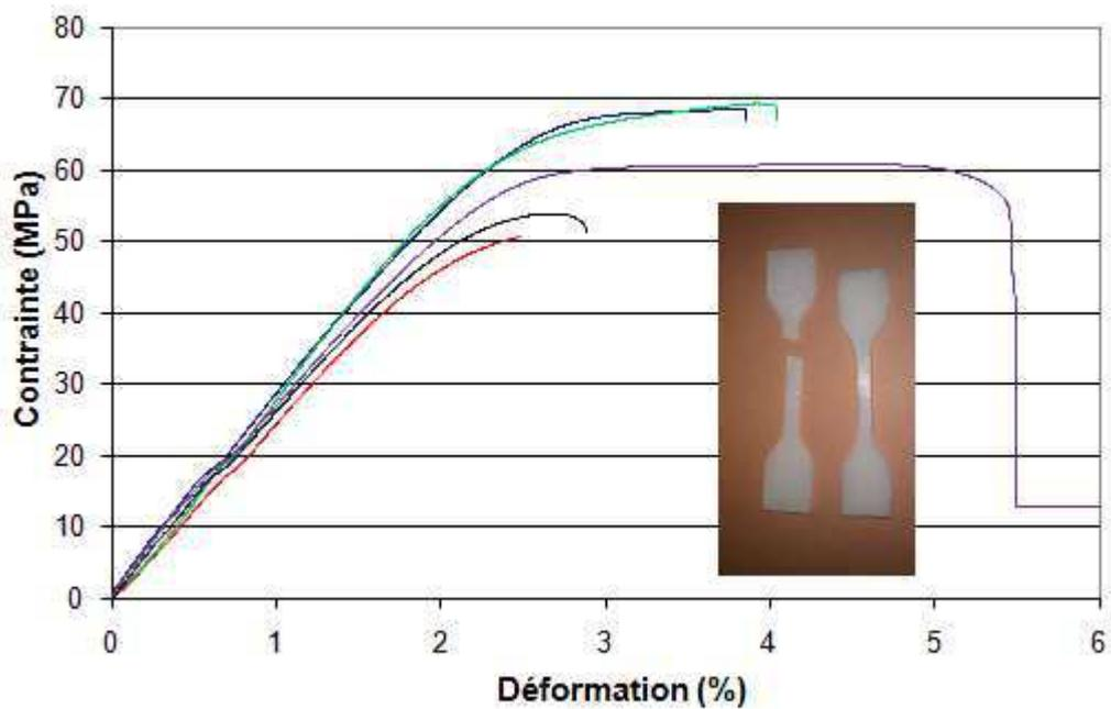
Figure 44 : Courbes de traction sur éprouvettes PA 6
