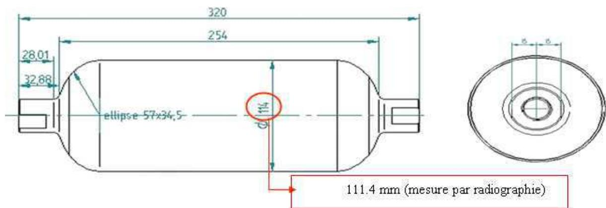
Figure 124 : Caractéristiques géométriques de l'assemblage embase-liner
