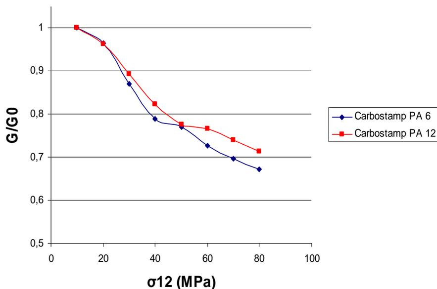
Figure 89 : Evolution de rigidité  $G/G_0$  de stratifié  $[\pm 45]_s$  de Carbostamp™ PA 12 et Carbostamp™ PA 6 en fonction de la contrainte imposée (vitesse de chargement 1 MPa/s, temps de relaxation 30 minutes)
