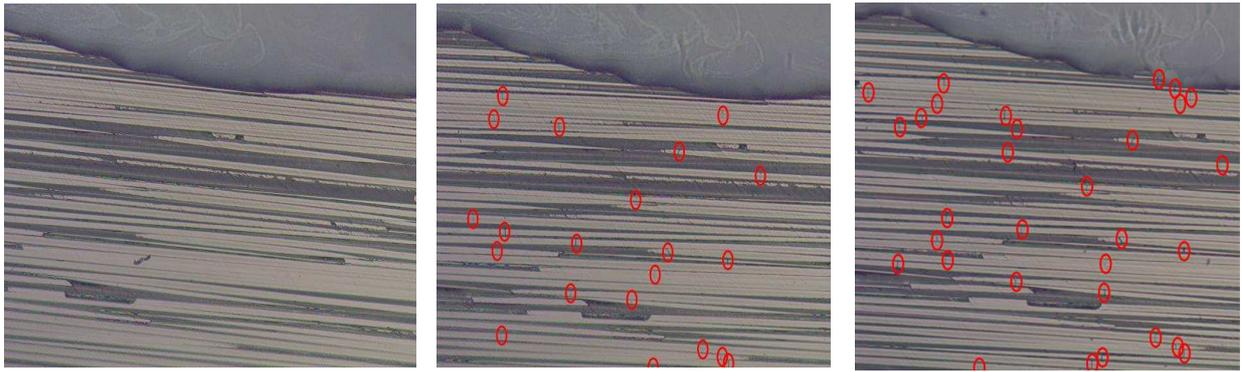
**Figure 99 : Accumulation des ruptures de fibres (entourées en rouge) dans un stratifié unidirectionnel Carbostamp™ PA 12 soumis à un chargement monotone-à 0 MPa (photo de gauche), 1600 MPa (photo du centre) et 2000 MPa (photo de droite)**
