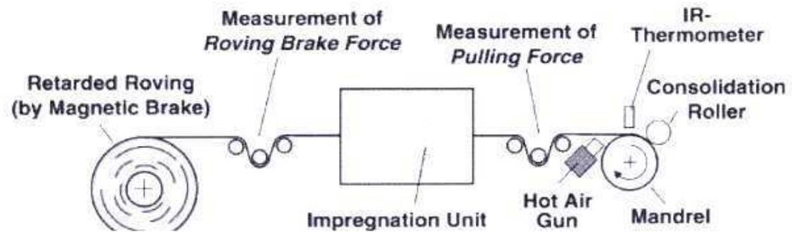
Figure 16 : Enroulement filamentaire de composites fibres de carbone/matrice polyamide avec imprégnation en ligne <sup>[83]</sup>
