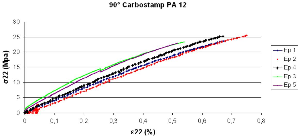
Figure 55 : Courbes d'essais de traction à rupture sur séquences  $[90^\circ]_8$  pour le Carbostamp™ PA 12 (Cellule de force 250 kN, vitesse de déformation 1 mm/min, suivi de l'allongement par extensomètre numérique de longueur de jauge 50 mm puis par déplacement de la traverse)
