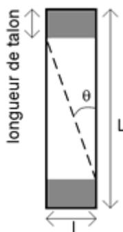
Figure 31 : Schéma d'une éprouvette EDT-  $L$  : longueur de l'éprouvette;  $l$  : largeur de l'éprouvette;  $e$  épaisseur de l'éprouvette <sup>[109]</sup>
