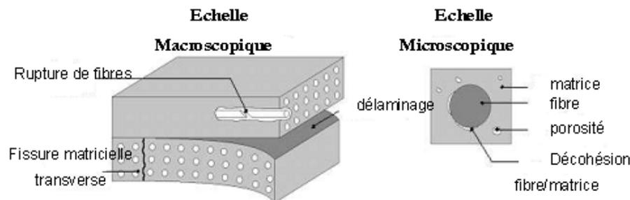
Figure 19: Principaux endommagements rencontrés dans un matériau composite <sup>[85]</sup>
