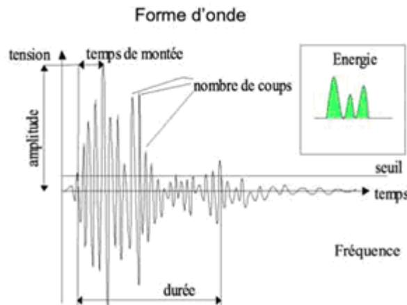
**Figure 23 : Paramètres calculés sur une salve d'émission acoustique <sup>[93]</sup>**
