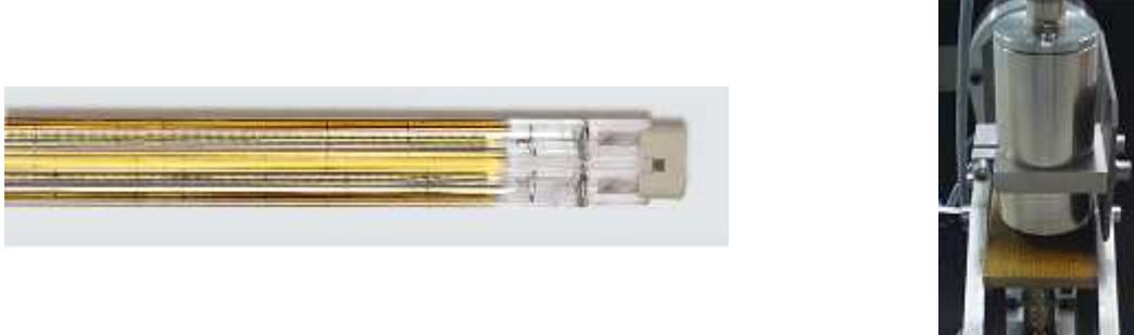
**Figure 103 : Emetteur infrarouge (photo de gauche) et pyromètre laser (photo de droite) utilisés respectivement pour le chauffage et la régulation de température au niveau de la tête de dépose**
