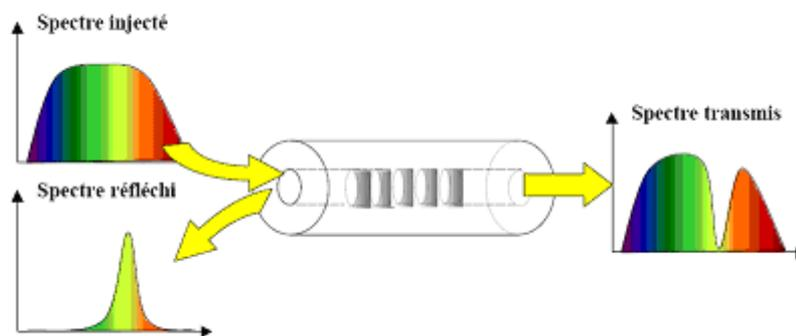
Figure 25 : Fonctionnement d'un réseau de Bragg <sup>[99]</sup>
