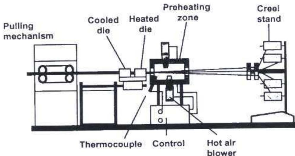
Figure 12 : Chaîne de fabrication de composites fibres de carbone/matrice polyamide à partir de pré imprégnés par pultrusion <sup>[59]</sup>
