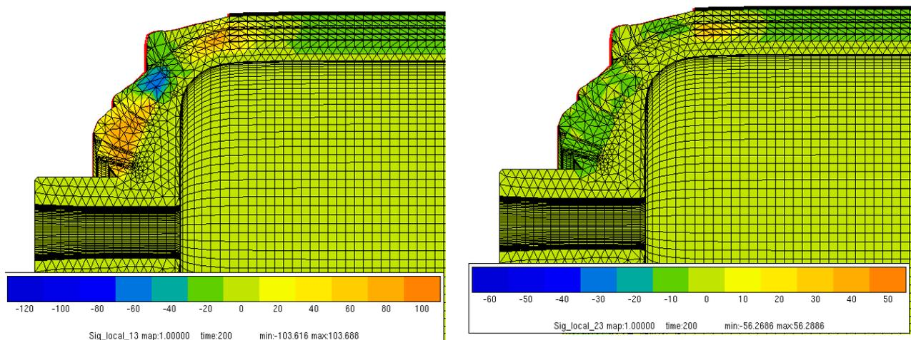
Figure 131 : Observation des contraintes locales de cisaillement entre les plis hélicoïdaux et les plis circonférentiels,  $\sigma_{13}$  (à gauche) et  $\sigma_{23}$  (à droite)
