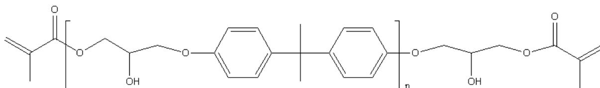
Figure 2 : Structure moléculaire d'une résine vinyle ester
