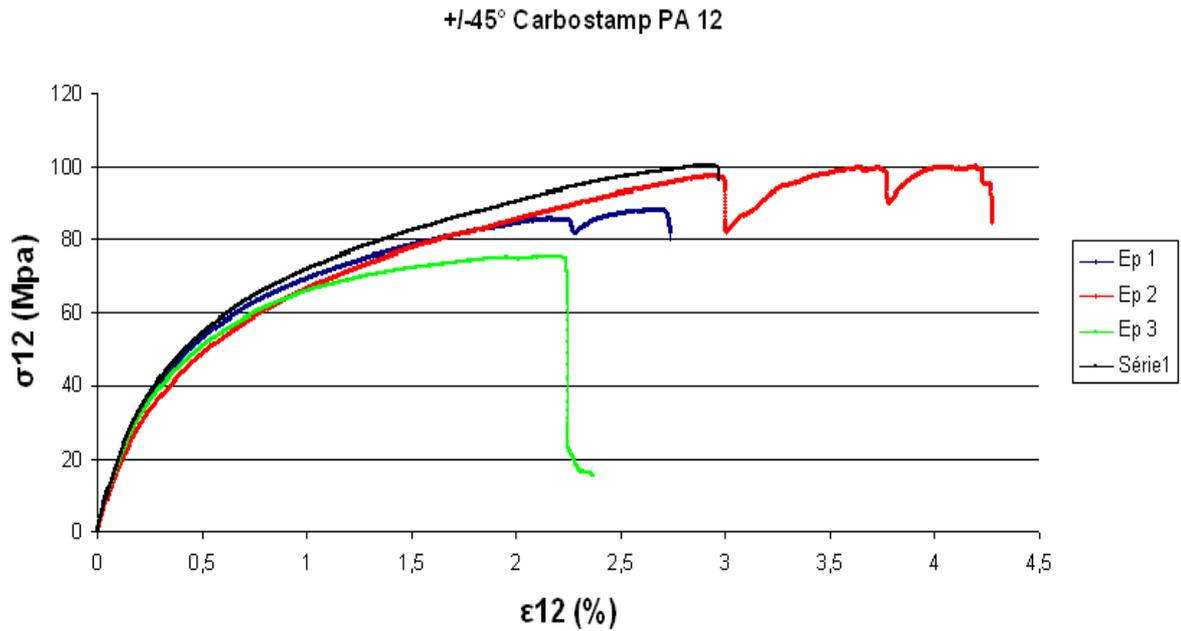
Figure 59 : Courbes d'essais de traction à rupture sur des séquences  $[\pm 45^\circ]_s$  de Carbostamp™ PA 12 (Cellule de force 250 kN, vitesse de déformation 1 mm/min, suivi de l'allongement par extensomètre numérique de longueur de jauge 50 mm puis par déplacement de la traverse)
