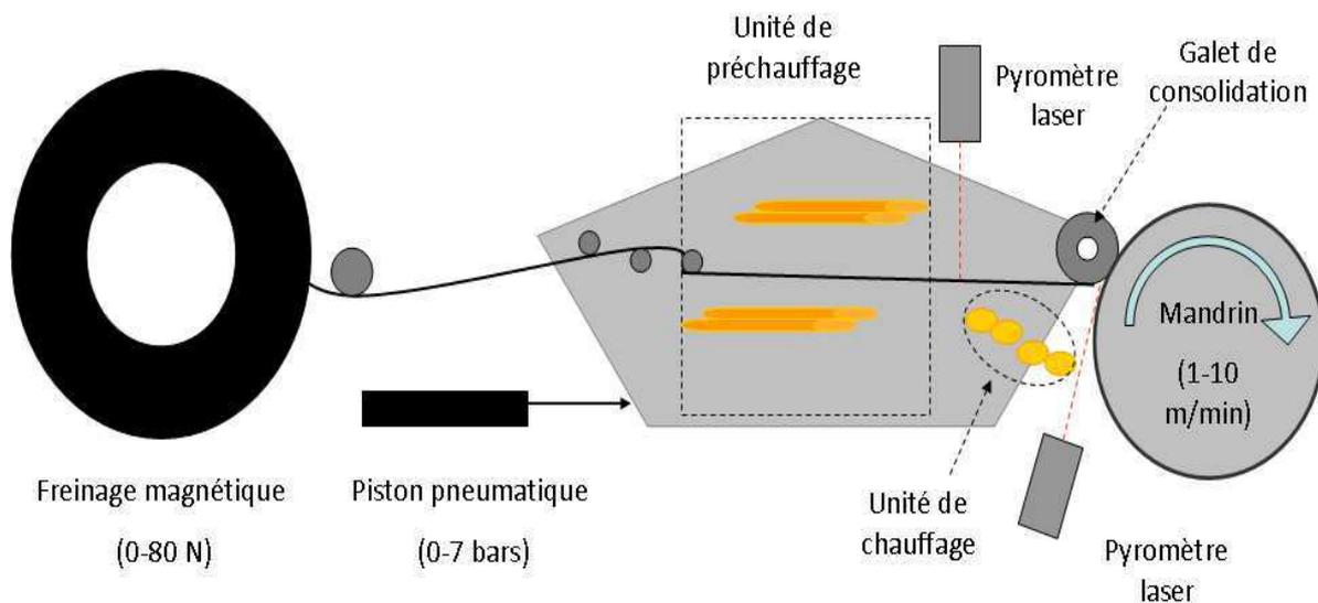
Figure 105 : Procédé d'enroulement filamentaire dédié aux composites fibres de carbone / matrice polyamide
