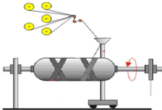
**Figure 13 : Procédé de fabrication des réservoirs composites par enroulement filamentaire**
