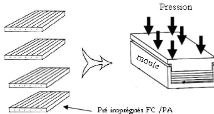
**Figure 11 : Principe de la mise en oeuvre de pré imprégnés polyamide par thermocompression**
