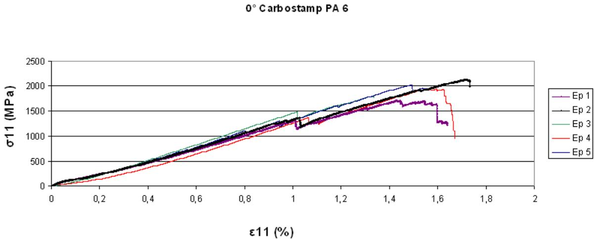
**Figure 52 : Courbe d'essais de traction à rupture sur séquences  $[0^\circ]_4$  pour le Carbostamp<sup>TM</sup> PA 6 (Cellule de force 250 kN, vitesse de déformation 2 mm/min, suivi de l'allongement par extensomètre numérique de longueur de jauge 50 mm puis par déplacement de la traverse)**
