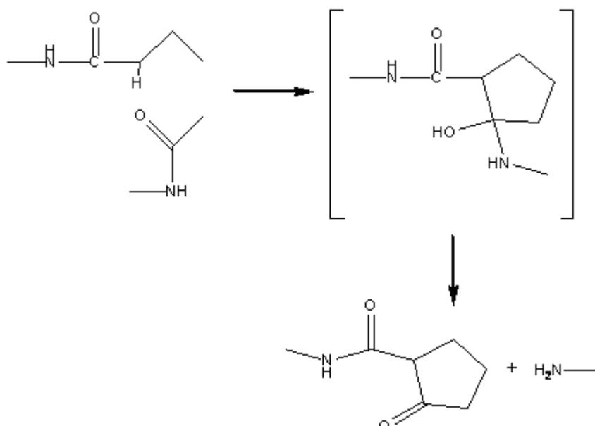
Figure 6 : Clivage de chaîne dans les matrices polyamides <sup>[34]</sup>
