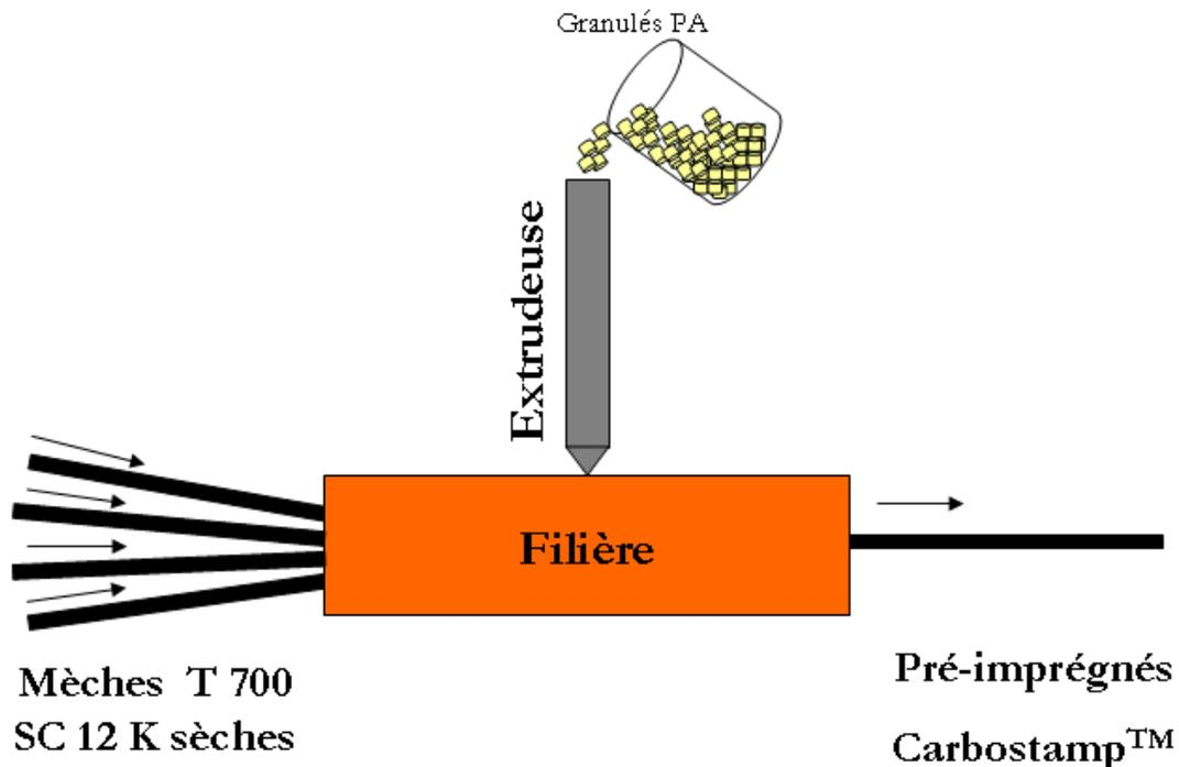
Figure 36 : Technique d'imprégnation des fibres de carbone dédiée à la fabrication des pré-imprégnés Carbostamp®
