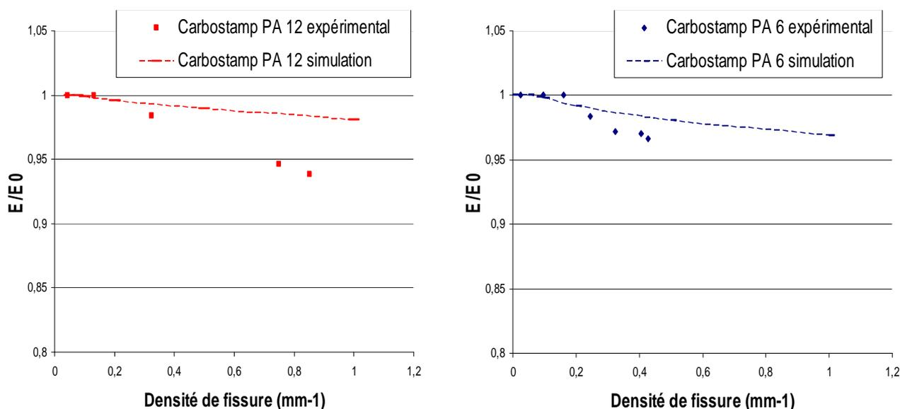
Figure 84 : Comparaison des évolutions de rigidités expérimentales et numériques pour le Carbestamp<sup>TM</sup> PA 12 (courbes de gauche) et le Carbestamp<sup>TM</sup> PA 6 (courbes de droite)
