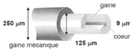
Figure 24 : Coupe de fibre optique<sup>[100]</sup>
