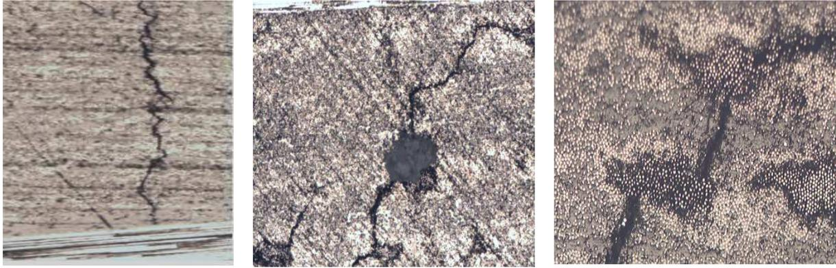
Figure 69 : Orientation d'une fissure dans les plis à 90° sans obstacle (x10, photo de gauche), en présence d'une porosité (x10 photo du centre), en présence d'une zone pauvre en matrice (x10, photo de droite)
