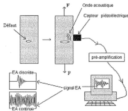
Figure 22 : Chaîne d'émission acoustique de la création de l'onde à sa visualisation <sup>[93]</sup>
