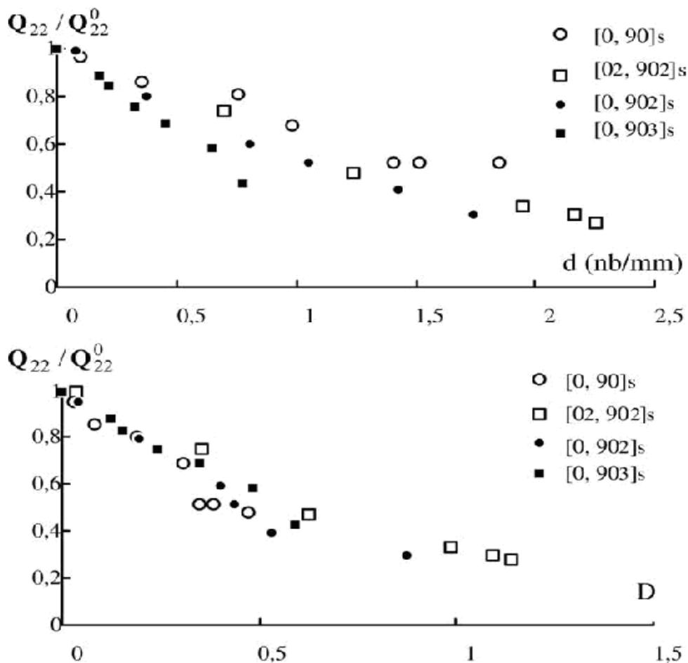
Figure 30 : Chute de rigidité transversale de stratifiés de séquences  $[0_n, 90_m]_s$  en fonction de la densité de fissure et de alpha (noté D ici) <sup>[105]</sup>
