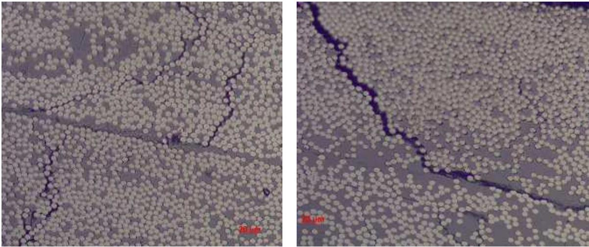
**Figure 86 : Endommagements apparaissant dans une séquence  $[\pm 45^\circ]_s$ , fissures transverses localisées dans les plis (x20, photo de gauche), délaminage en pointe de fissure (x20, photo de droite)**
