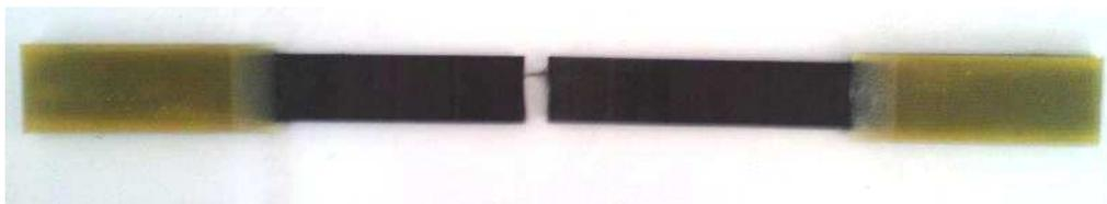
**Figure 57 : type de rupture rencontrée pour une séquence de type [90°]<sub>8</sub>**
