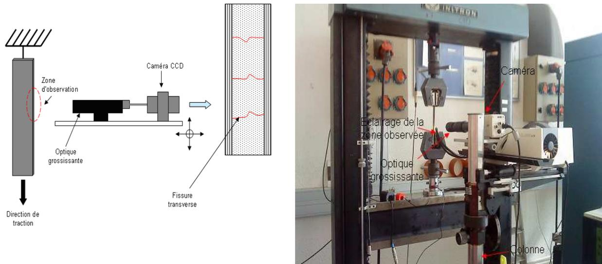
Figure 68 : Schéma et photographie du montage pour l'observation des fissures intralaminaires sur une séquence de  $[0^\circ, 90^\circ]_s$
