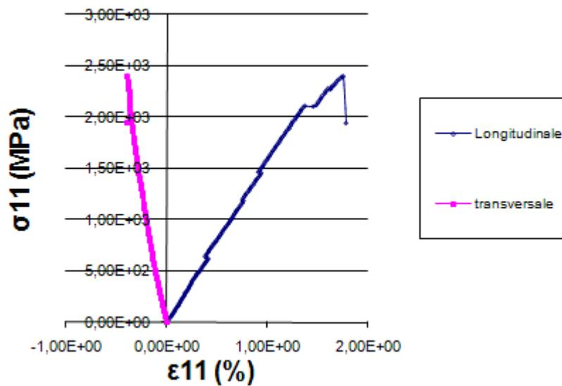
Figure 54 : Essais de traction sur séquence  $[0^\circ]_4$  avec mesure des déformations longitudinale et transversale (exemple d'une éprouvette de Carbostamp™ PA 6)
