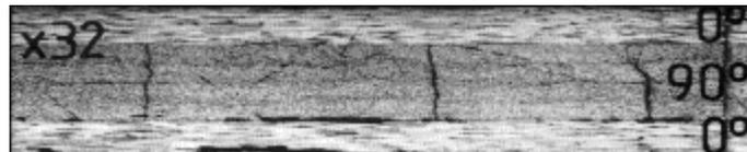
Figure 28 : Fissures transverses dans un stratifié  $[0_n, 90_m]_s$  [105]
