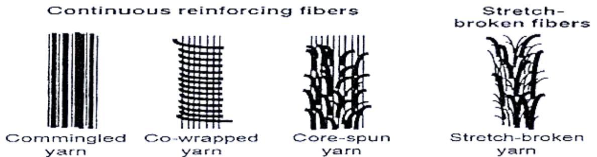
Figure 9 : Différentes architectures de commelés fibres de carbone/fibres de polyamide <sup>[50]</sup>
