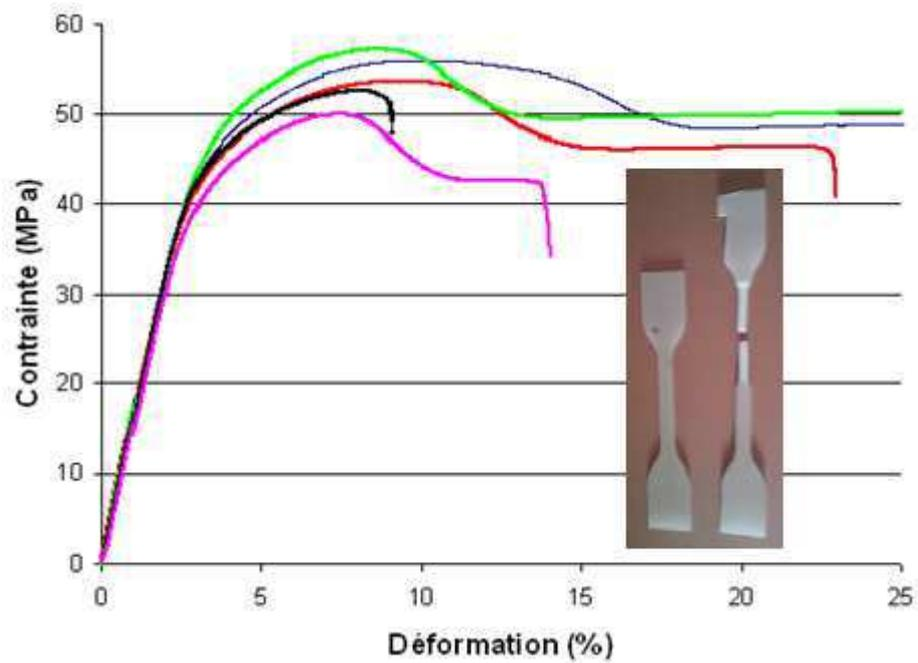
Figure 43 : Courbes de traction sur éprouvettes PA 12
