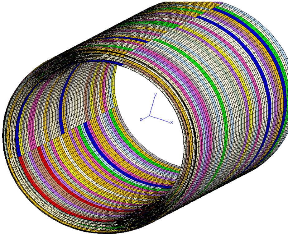
Figure 132 : Répartition des VES dans les plis circonférentiels du réservoir
