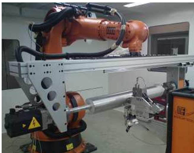
**Figure 37 : Machine d'enroulement filamentaire MF Tech**
