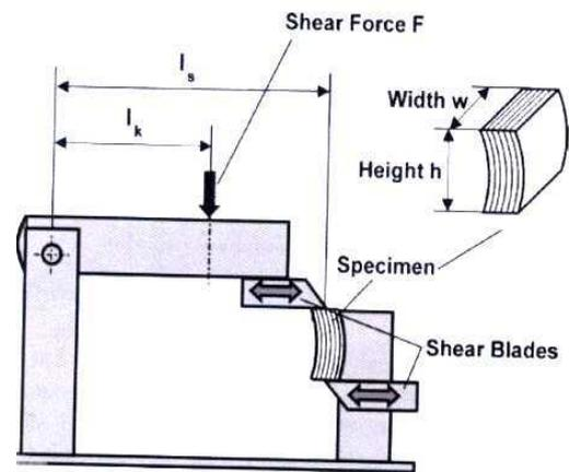
Figure 18 : Principe de l'essai de cisaillement interlaminaire selon Lauke <sup>[83]</sup>
