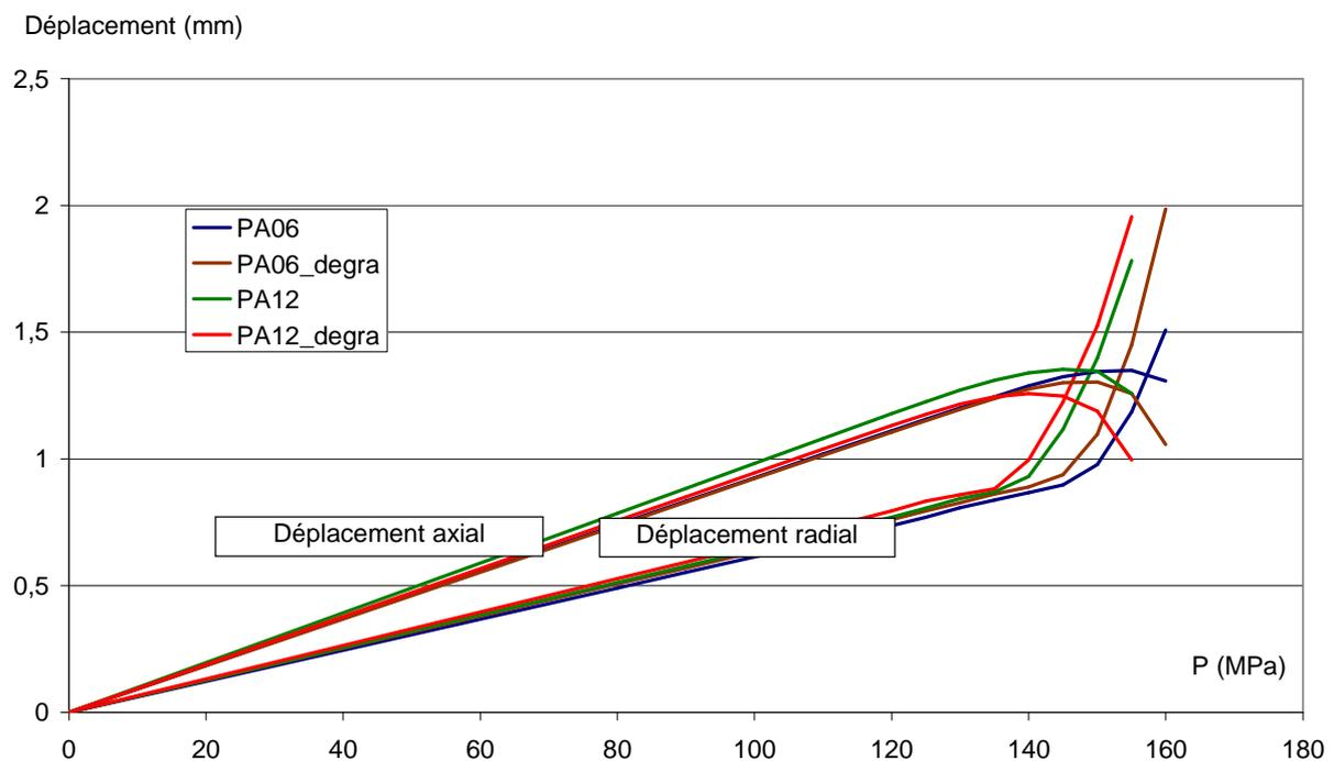
Figure 134 : Influence de la fissuration dans les plis à  $90^\circ$ ,  $\pm 62^\circ$  et  $\pm 56^\circ$  sur l'évolution des déformations radiales et axiales du réservoir en fonction de la pression appliquée
