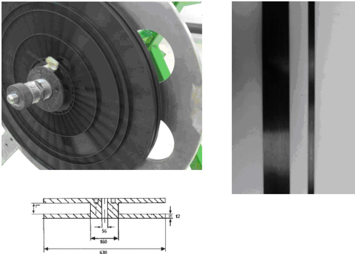
Figure 35 : Cassettes de stockage du Carbostamp® - largeurs de nappes utilisées
