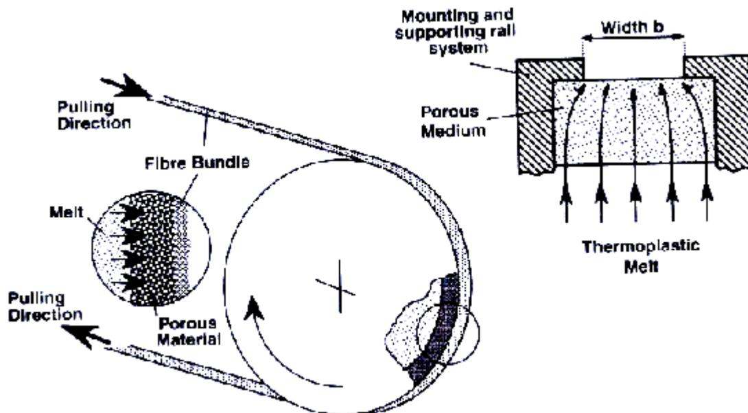
Figure 15 : Imprégnation de fibres de carbone par une matrice polyamide par injection à travers un anneau poreux<sup>[82]</sup>
