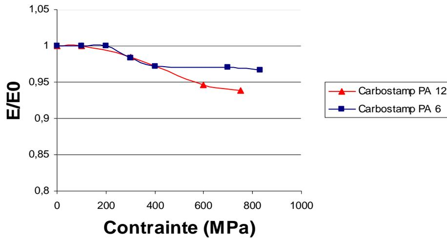
Figure 81 : Evolution de rigidité  $E/E_0$  de stratifiés  $[0^\circ_2, 90^\circ_2]_s$  de Carbostamp<sup>TM</sup> PA 12 et Carbostamp<sup>TM</sup> PA 6 en fonction de la contrainte appliquée
