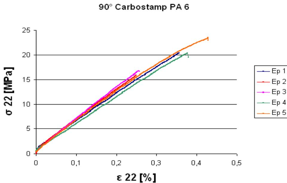
Figure 56 : Courbes d'essais de traction à rupture sur séquence  $[90^\circ]_8$  pour le Carbostamp™ PA 6 (Cellule de force 250 kN, vitesse de déformation 1 mm/min, suivi de l'allongement par extensomètre numérique de longueur de jauge 50 mm puis par déplacement de la traverse)
