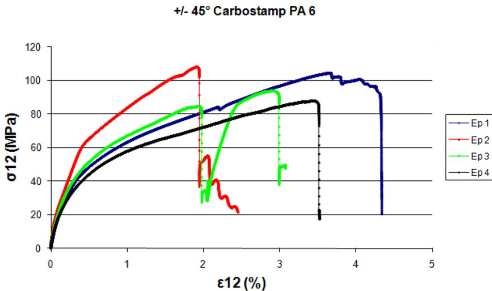
Figure 60 : Courbes des essais des traction à rupture sur séquences  $[\pm 45^\circ]_s$  de Carbostamp™ PA 6 (Cellule de force 250 kN, vitesse de déformation 1 mm/min, suivi de l'allongement par extensomètre numérique de longueur de jauge 50 mm puis par déplacement de la traverse)
