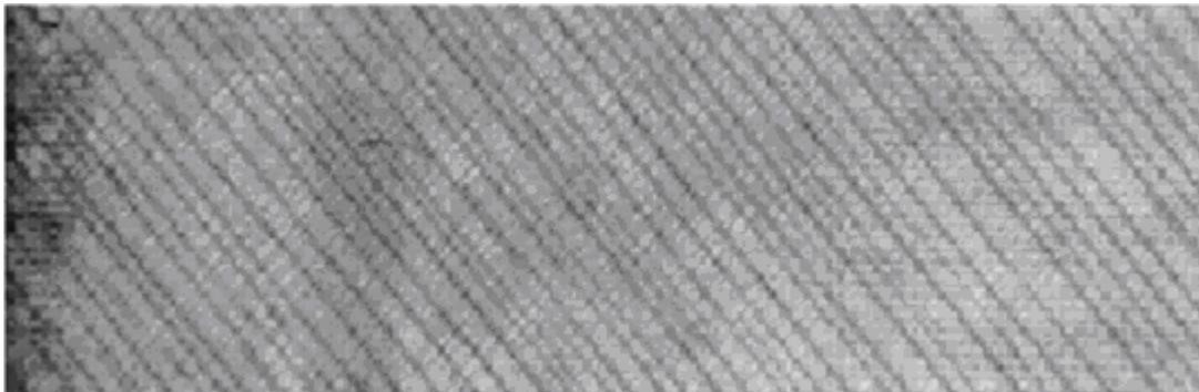
**Figure 20 : Mise en évidence de fissures par radiographie X de stratifiés composites <sup>[87]</sup>**
