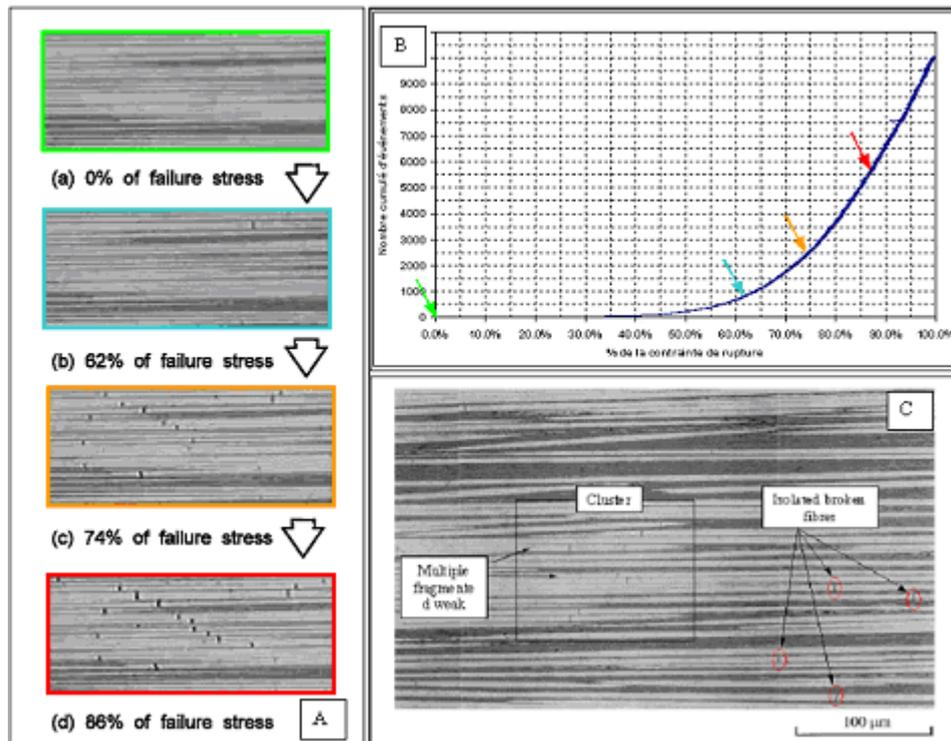
Figure 32 : Illustration de l'endommagement par rupture de fibres de la séquence [0s]<sup>[8]</sup>,
