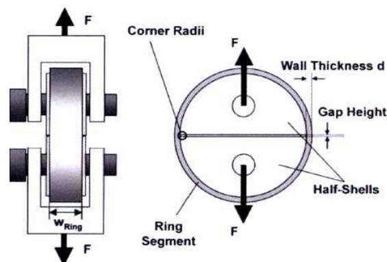
Figure 109 : Dispositif de traction sur anneau composite suivant la norme ASTM D 2290 (Henninger<sup>[82, 83]</sup>)
