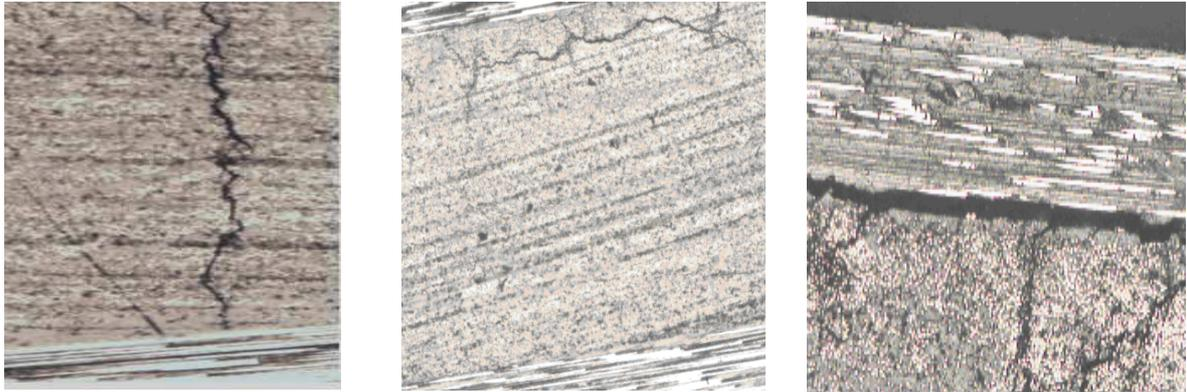
**Figure 72 : Développement des endommagements lors d'un chargement/déchargement répété progressif d'une séquence  $[0^\circ_2, 90^\circ_2]_s$ -apparition de fissures transverses ( $150 \text{ MPa} < \sigma < 600 \text{ MPa}$ ), apparition de fissures longitudinales et de délaminage ( $\sigma > 700 \text{ MPa}$ )**
