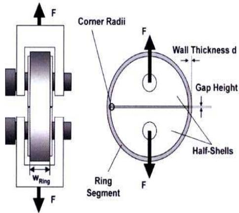
Figure 17 : Principe de l'essai de traction sur anneau composite <sup>[83]</sup>, essai NOL (ASTM D 2290)
