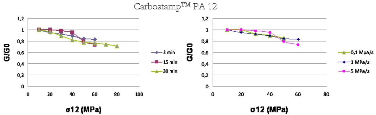
Figure 90 : Influence du temps de relaxation à contrainte nulle (graphique de gauche) et de la vitesse de chargement (graphique de droite) sur l'évolution du module de cisaillement en fonction du chargement imposé pour le Carbostamp™ PA 12
