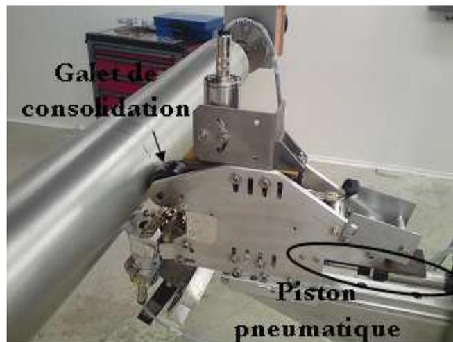
**Figure 104 : Système de consolidation de la nappe sur le mandrin**
