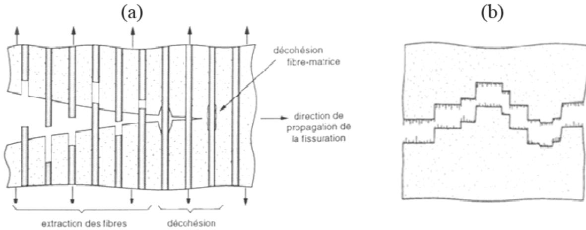
Figure 33 : Mécanisme d'endommagement et surface de rupture d'un stratifié UD présentant une faible adhésion fibre/matrice [114]
