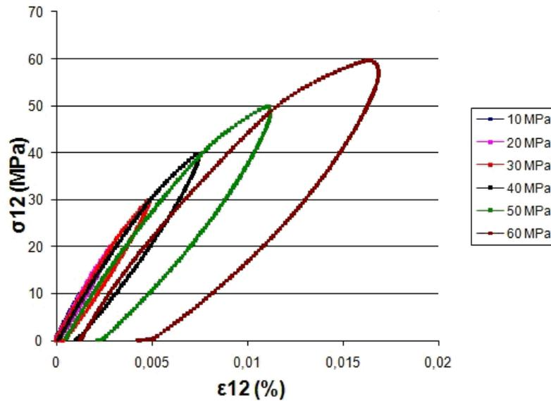
Figure 62 : Chargement répétitif progressif d'une éprouvette  $[\pm 45]_s$  (exemple d'une éprouvette de Carbostamp<sup>TM</sup> PA 12)
