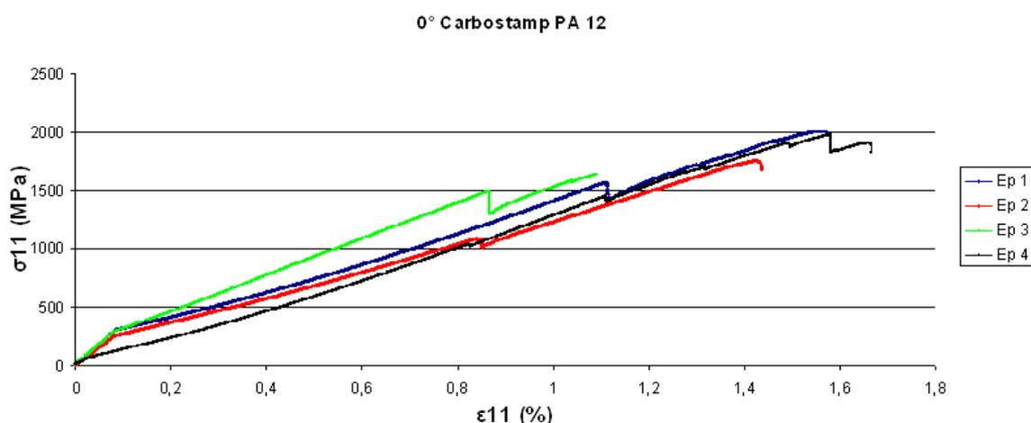
Figure 51 : Courbe d'essais de traction à rupture sur séquences  $[0^\circ]_4$  pour le Carbostamp™ PA 12 (Cellule de force 250 kN, vitesse de déformation 2 mm/min, suivi de l'allongement par extensomètre numérique de longueur de jauge 50 mm puis par déplacement de la traverse)
