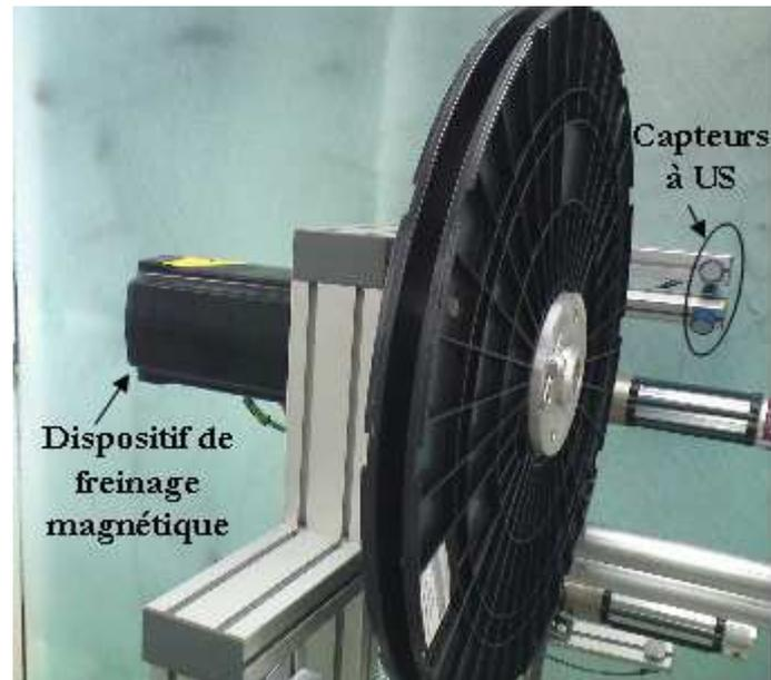
Figure 102 : Dispositif de freinage magnétique et contrôle par capteurs à ultrasons choisis pour le procédé
