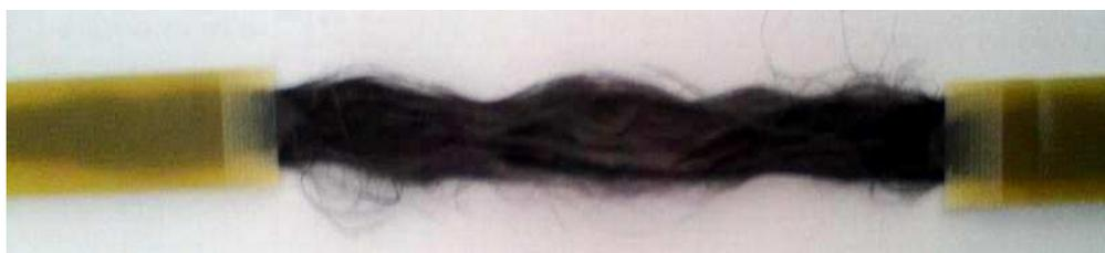
**Figure 40 : Ruban de fibre de carbone après essai**
