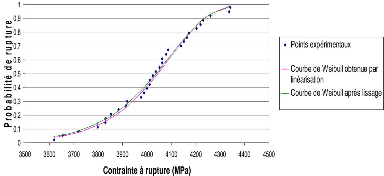
Figure 95 : Evolution de la probabilité à rupture de mèche de fibres de Carbone de type T700™ en fonction de la contrainte appliquée (loi statistique de type Weibull)
