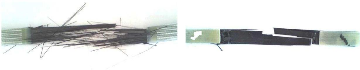
**Figure 53 : Différents types de ruptures rencontrées pour les séquences  $[0^{\circ}]_4$  ;**
