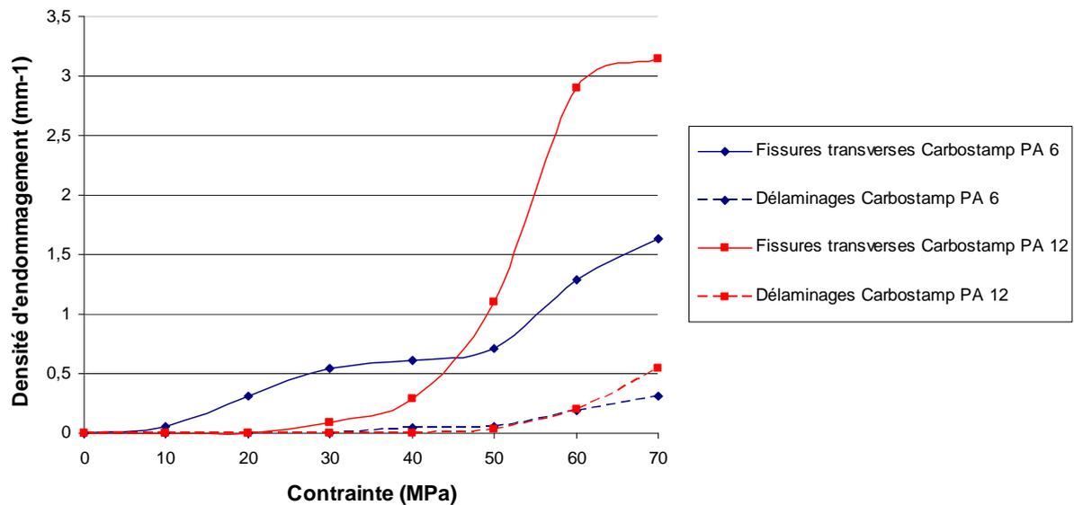
Figure 87 : Courbes expérimentales de densités de fissures transverses et de délaminages au cours du chargement imposé pour les séquences  $[\pm 45]_s$  de Carbostamp™ PA 12 et Carbostamp™ PA 6
