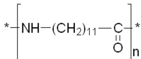
Figure 5 : Formule chimique du polyamide 12
