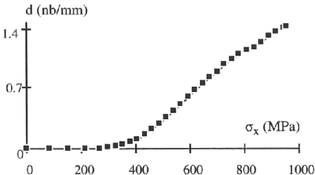
Figure 29 : Evolution de la densité de fissure au sein du pli à  $90^\circ$  d'un stratifié carbone/epoxy de séquence  $(0^\circ, 90^\circ)$  en fonction de la contrainte de traction monotone <sup>[108]</sup>
