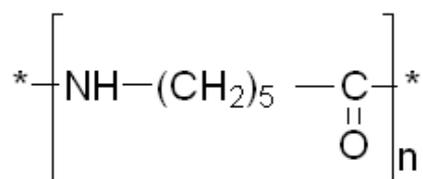
Figure 4 : Formule chimique du polyamide 6
